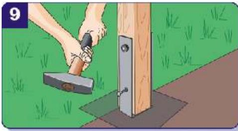
Nach Befestigung der Schrauben die Pfostenstellung nochmals kontrollieren und zweite Bohrung durchführen. Beide Schrauben mit Muttern fixieren und festziehen.
