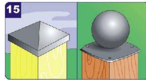
Der optimale Schutz der Pfostenenden: Abdeckkappen mit oder ohne Verzierung. Holz- oder Metallplatten.
