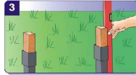
Mit einer Wasserwaage mehrmals prüfen um den senkrechten Stand der Hülsen zu gewährleisten.
