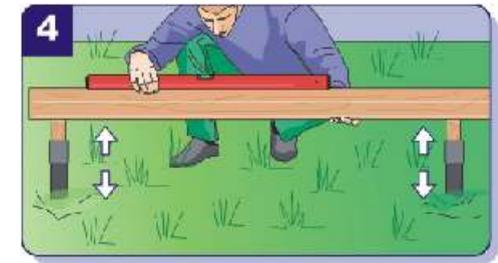
Mit Hilfe einer Holzlatte und einer Wasserwaage richten Sie die Höhe der Einschlaghülsen aus.
